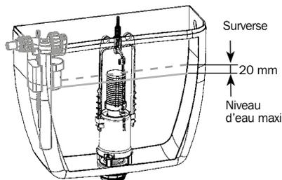
NB : Le niveau d'eau maxi doit se trouver à 20 mm en dessous du tube de surverse (j)
