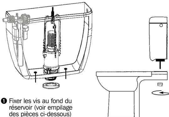
❶ Fixer les vis au fond du réservoir (voir empilage des pièces ci-dessous)
