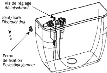
Schroef manuelle de moer van het vlotterkraan vast tot ze in contact komt met het keramiek. Indien nodig schroeft u ze (maximaal) een bijkomende kwartslag vast met de speciale sleutel.
